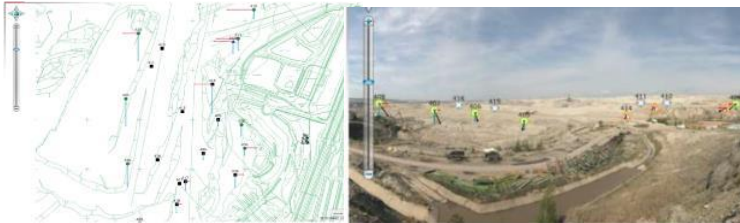
Stały monitoring zwałowiska (czujniki ciśnienia porowego)
